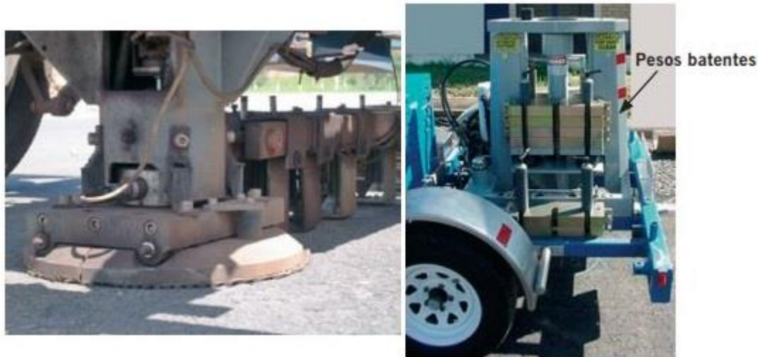
Figura 6 - Detalhe dos sensores e pesos batentes do FWD
