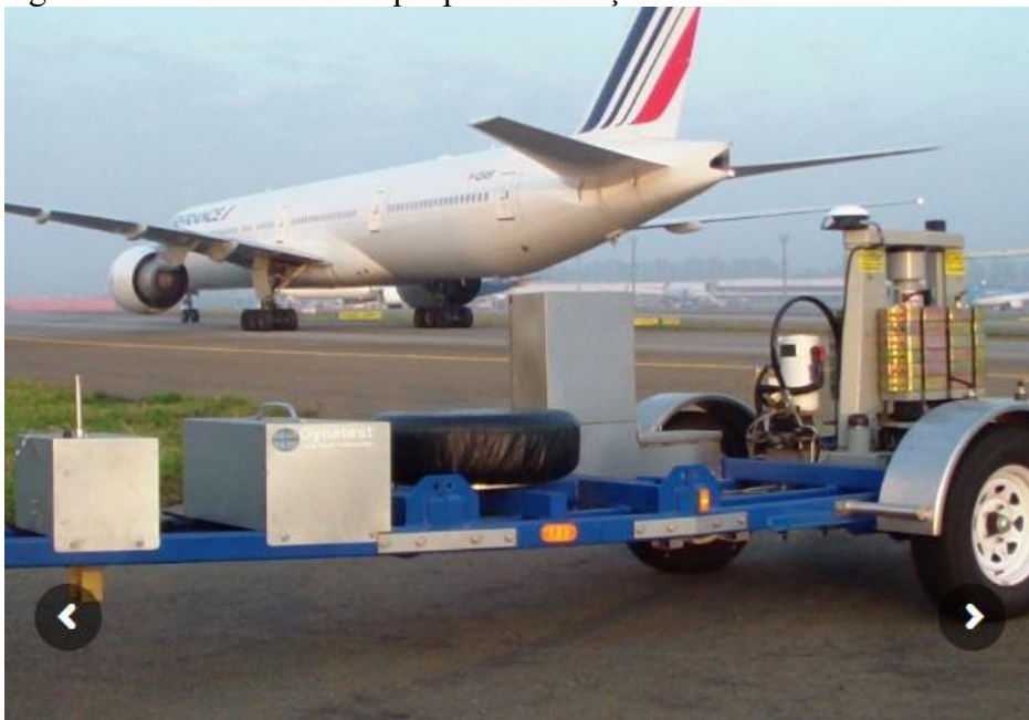
Figura 5 - FWD sobre reboque para realização de ensaio
