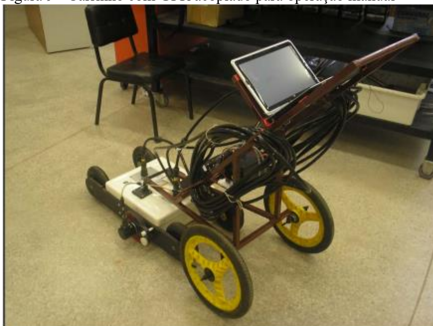
Figura 9 - Carrinho com GPR acoplado para operação manual
