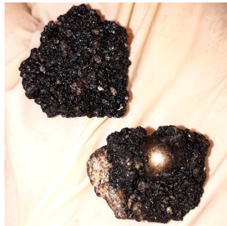
(b) Grumos formados pelas partículas e esfera
