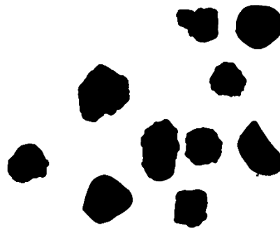
Figura 11 - Imagem obtida pelo AIMS para a análise de angularidade da amostra A12 (#2,36mm)
