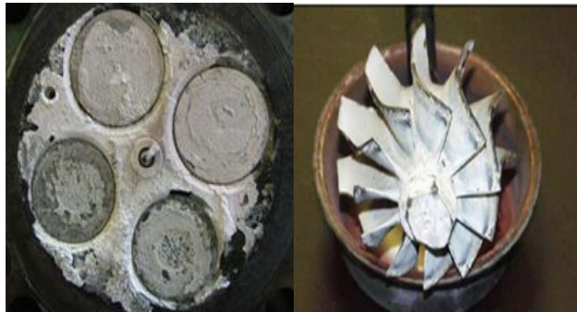
Figura 6: Componentes do motor danificados pela presença de siloxanos
