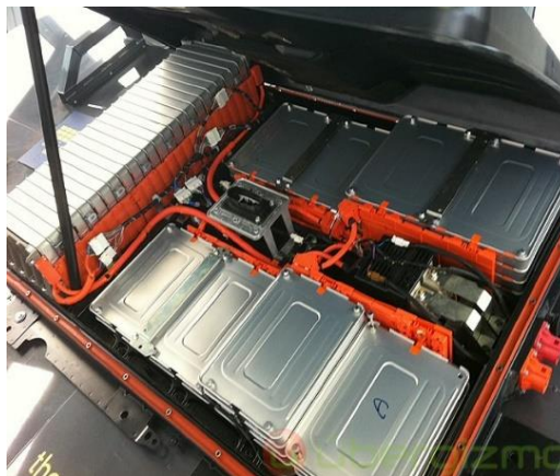
Figura 2.8 – Vista do interior do compartimento de baterias do modelo Nissan Leaf.
