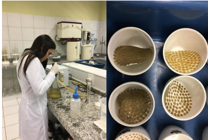
Figura 34 - Análise de sólidos totais pelo método da filtragem
