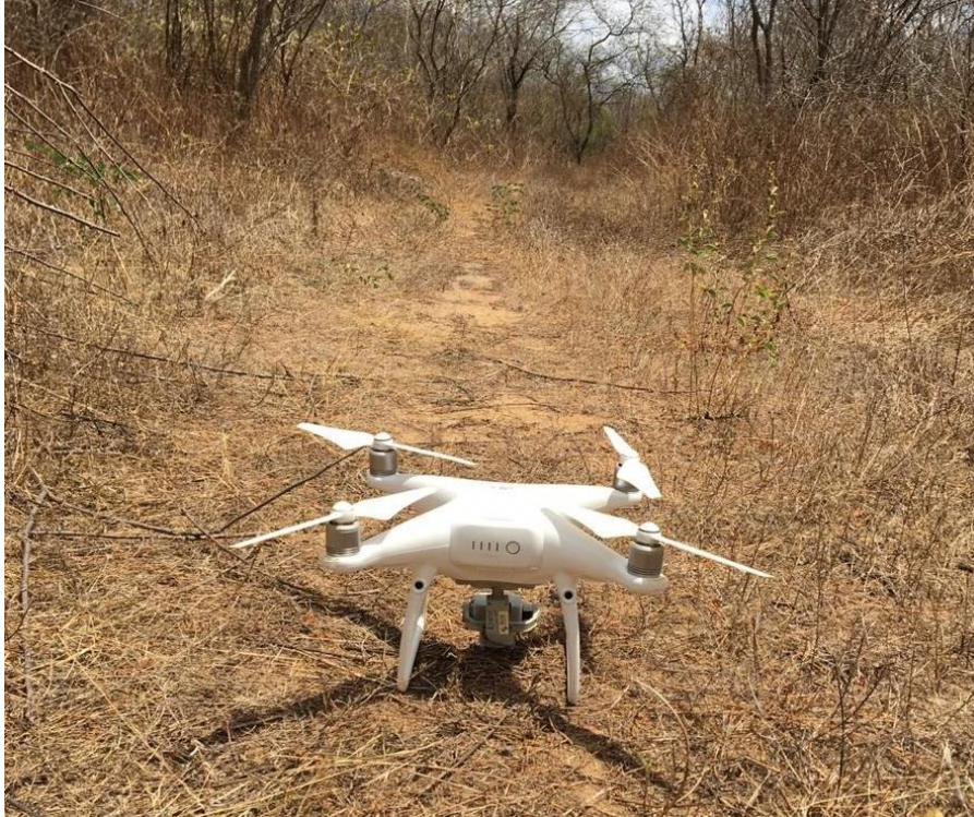
Figura 2. Modelo de RPA multirotor (Phantom 3, DJI)
