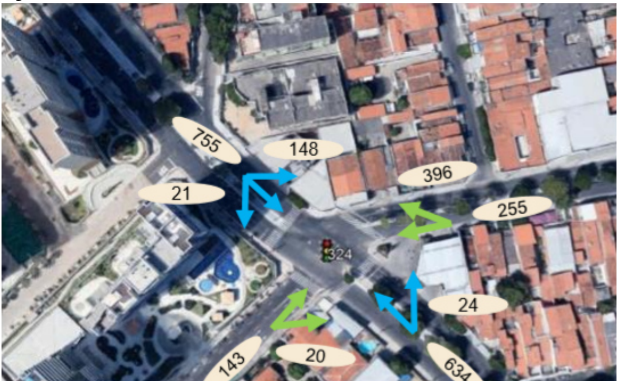
Figura 11 – Volumes na Av. Humberto Monte x Rua José de Pontes
