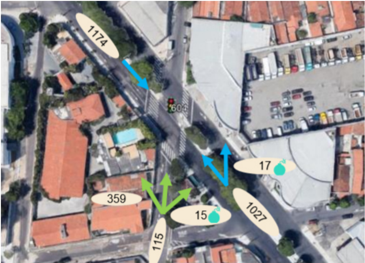
Figura 10 – Volumes na Av. Humberto Monte x Rua José de Pontes
