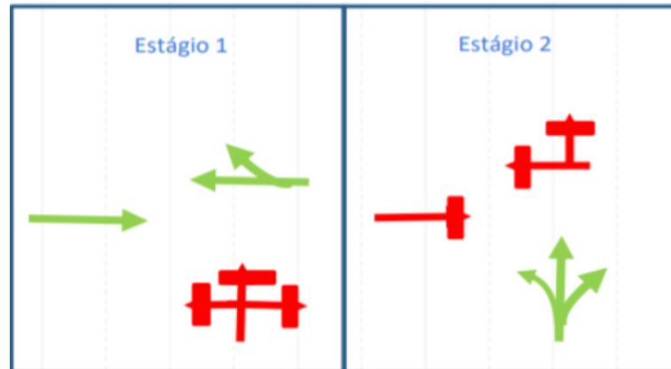
Quadro 2 – Estágios semafóricos na Av. Humberto Monte x Rua José de Pontes
