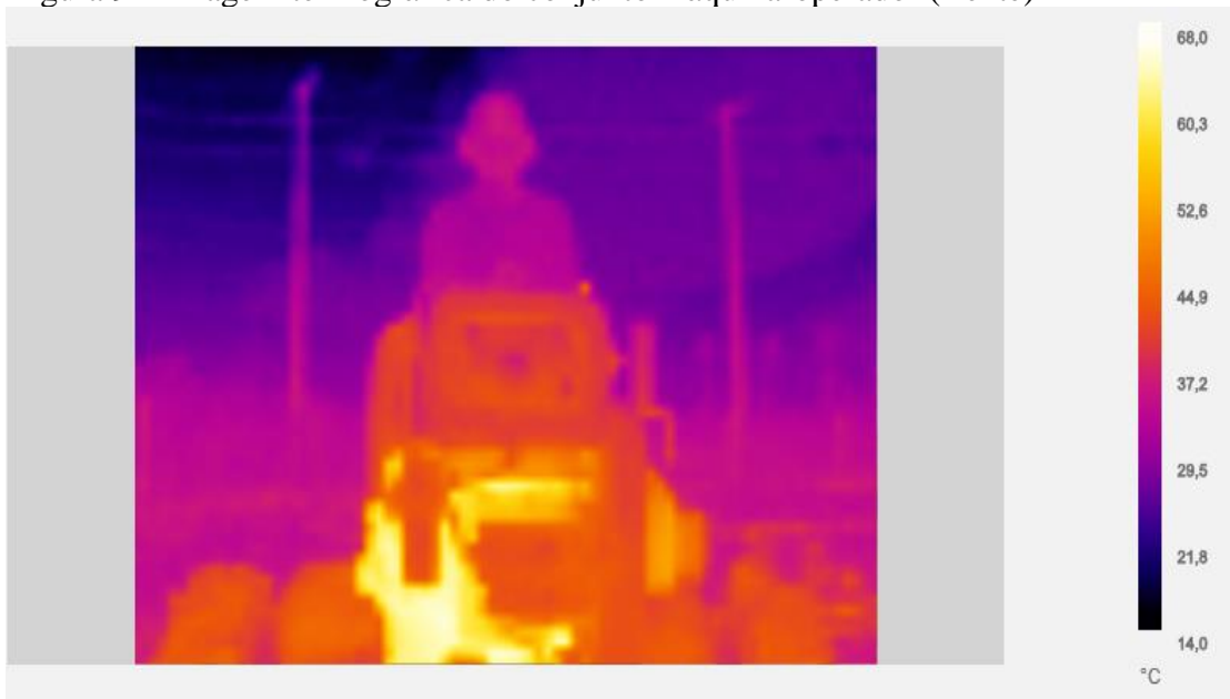
Figura 9 – Imagem termográfica do conjunto máquina-operador (frente)
