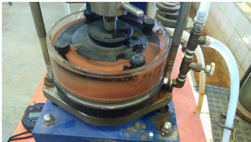
Figura 18 – Carreamento de material no ensaio de permeabilidade
