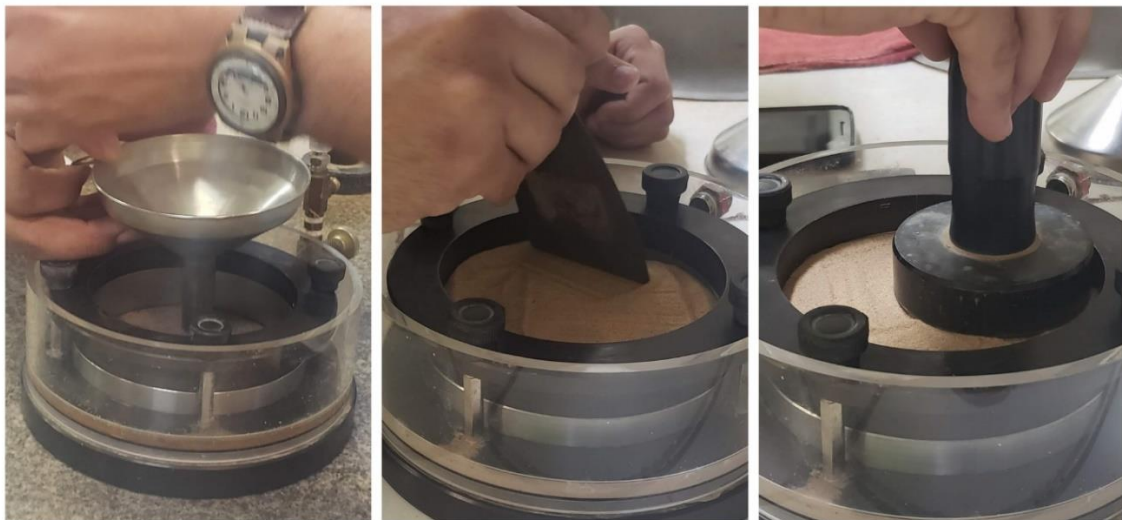
Figura 15 – Etapas da montagem do corpo de prova
