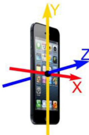
Figura 1 – Orientação dos eixos de detecção das componentes de aceleração
