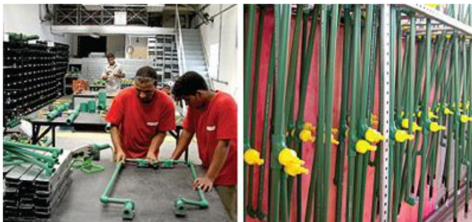
Figura 16 - Kits hidráulicos montados em central e entregues prontos no canteiro de obra
