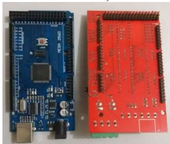
Figura 43 – Arduino com RAMPS (parte traseira).
