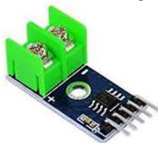
Figura 23 – Módulo MAX6675 para termopar.
