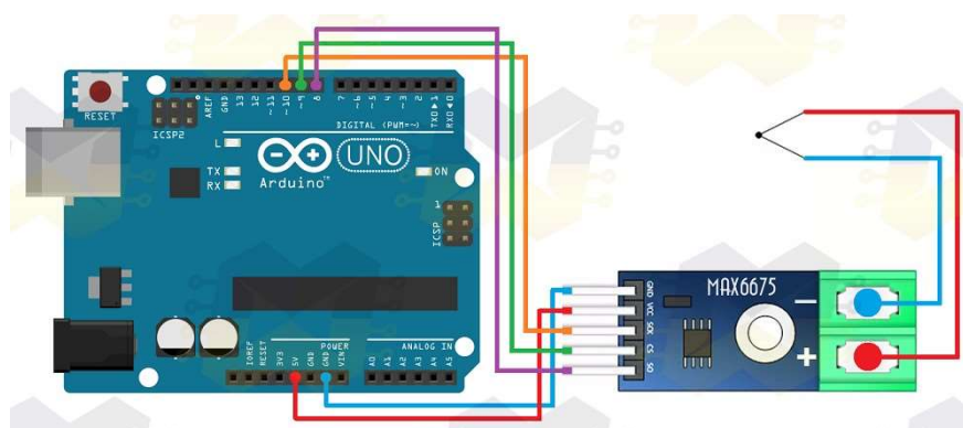
Figura 24 – Esquema de ligação de um termopar e drive Max6675 no Arduino UNO.
