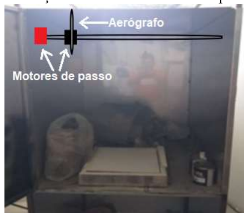
Figura 26 – Simulação de inclusão motores de passo e aerógrafo.
