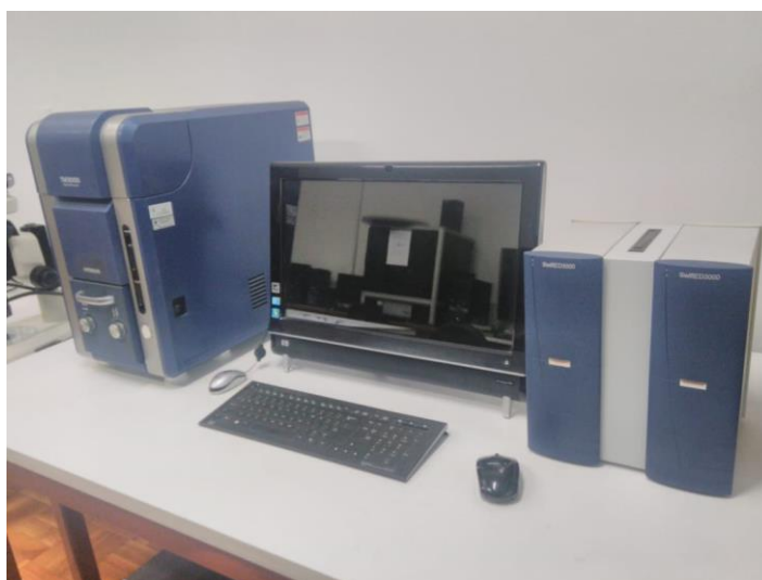
Figura 25 - Microscópio eletrônico de varredura com detector de EDS
