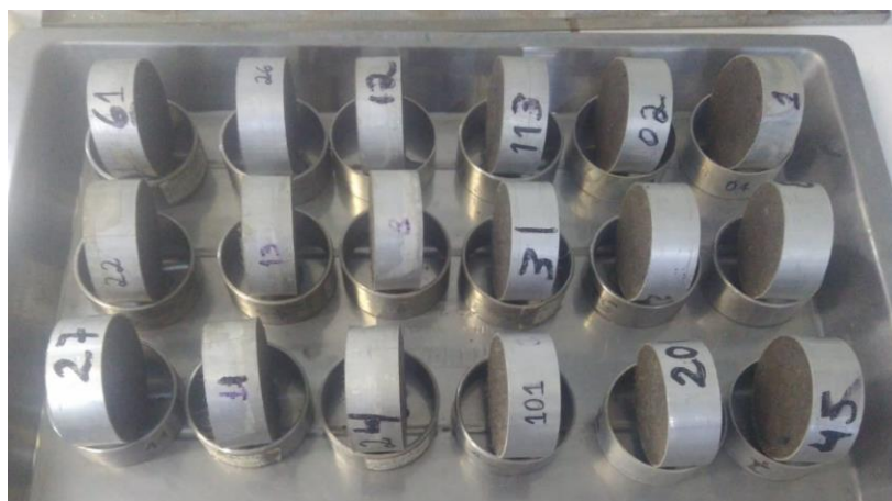
Figura 22 - Corpos de prova posicionados para a secagem
