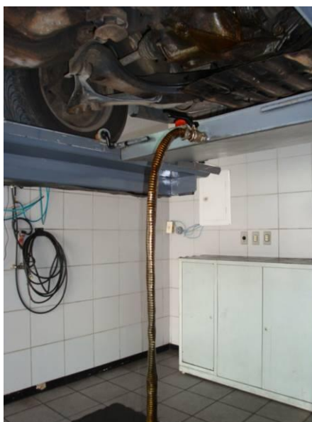
Figura 5 – Coleta por sucção na troca de óleo.
