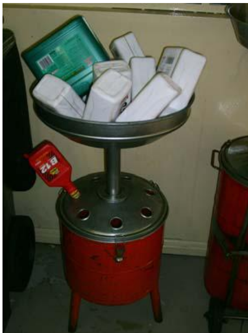
Figura 4 – Modelo correto de coleta de resíduo de óleo lubrificante da embalagem plástica
