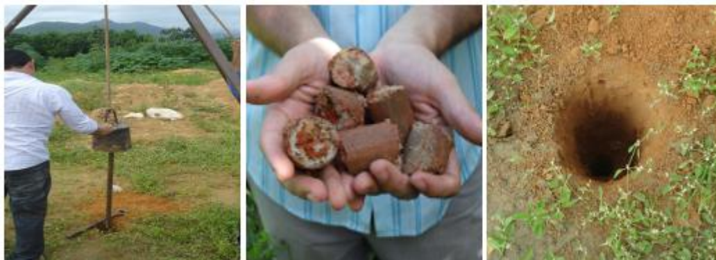
Figura 6 - Vista do processo de realização do ensaio SPT na área da CE, 2011
