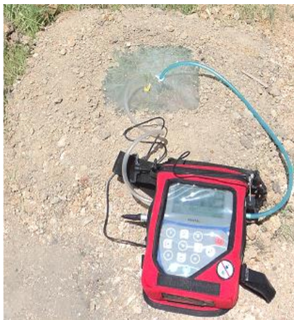
Figura 28 - Vista do GEM2000 conectado à placa na cobertura, 2011
