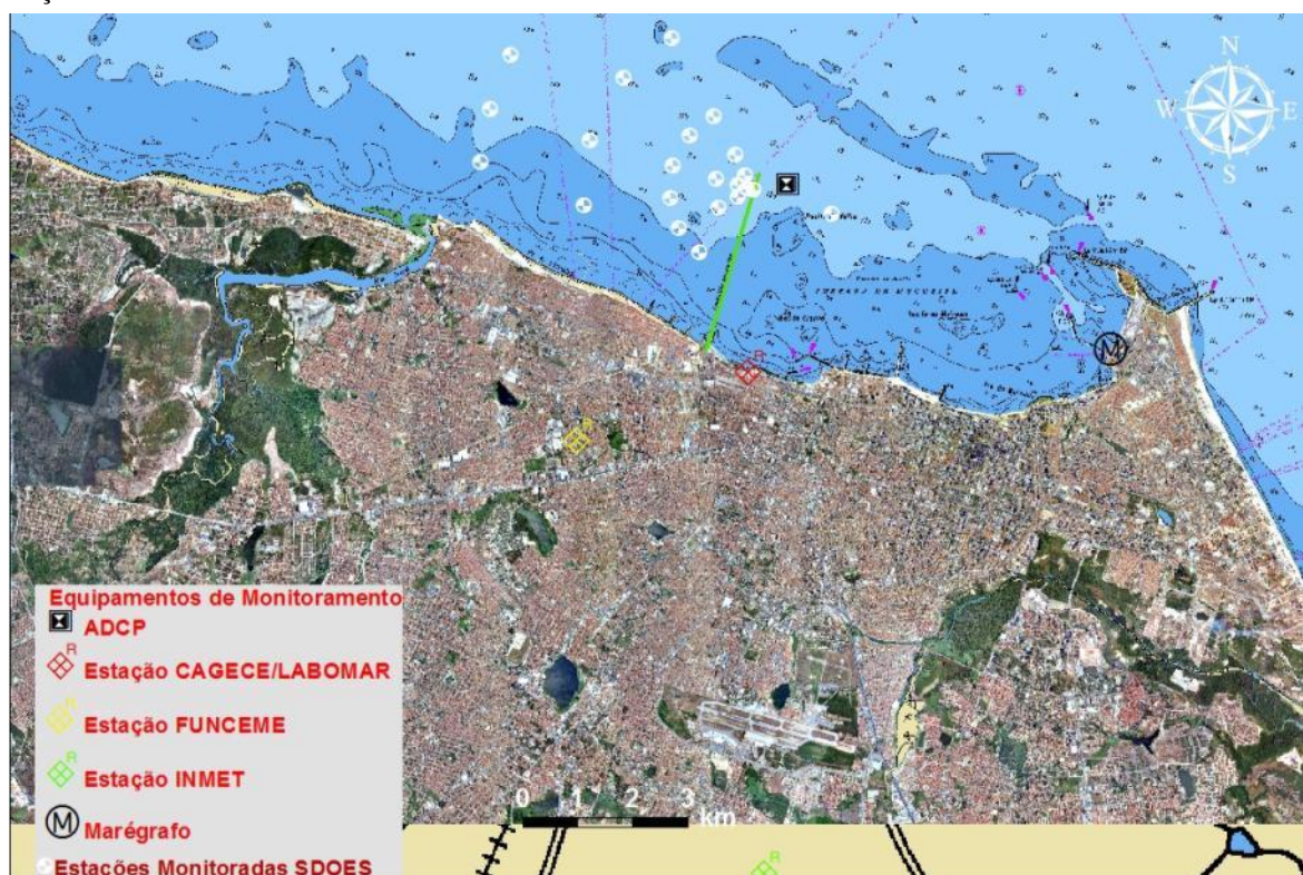
Figura 34 – Localização das estações meteorológicas e maregráficas utilizadas, além do correntômetro (ADCP) e estações de monitoramento do SDOES.
