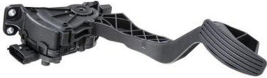
(a) Pedal do acelerador com sensor eletrônico de posição.
