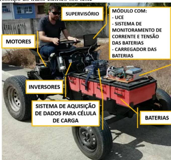
(a) Trator elétrico com estrutura para ensaios
