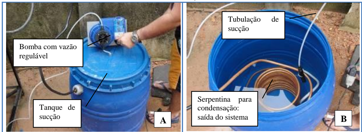
Figura 3.16 - Peças responsáveis pelo fluxo de entrada e saída da urina do concentrador. (A) - Bomba com vazão regulável e tanque. (B) - tubulação de sucção e serpentina de condensação. Fortaleza-CE, 2010.
