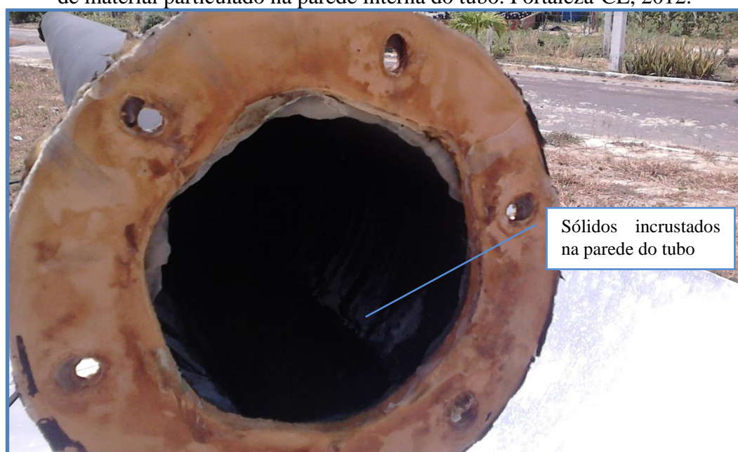
Figura 3.34 –Tubo absorvedor de 100 mm aberto após o experimento. Detalhe da existência de material particulado na parede interna do tubo. Fortaleza-CE, 2012.
