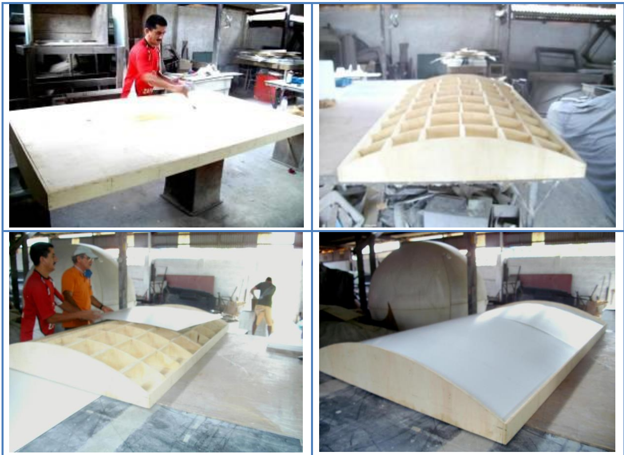
Figura 3.13 – Conjunto de imagens apresentando o acompanhamento das etapas de confecção da superfície parabólica de fibra de vidro, fixação e alinhamento dos perfis em madeira. Fortaleza-CE, 2009.
