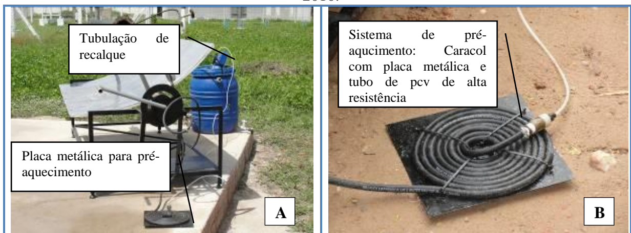
Figura 3.17 - (A) Tubulação de recalque (B) – Sistema de pré-aquecimento. Fortaleza-CE, 2010.
