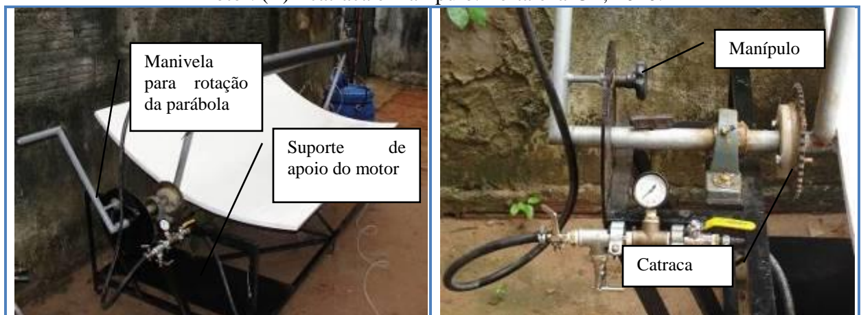
Figura 3.15 – Peças e equipamentos responsáveis pelo movimento de rotação da parábola concentradora de energia solar. (A) - manivela para rotação da parábola e suporte de apoio do motor. (B) - catraca e manípulo. Fortaleza-CE, 2010.
