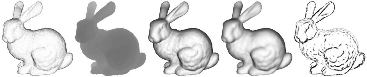
Figura 20 – Pipeline da detecção de silhueta em espaço de imagem proposta em (ZHANG et al. , 2014).
