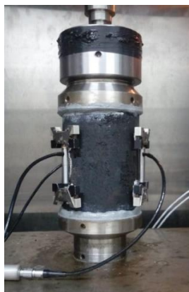
Figura 14 – Representação de um CP no ensaio uniaxial por tração-compressão direta
