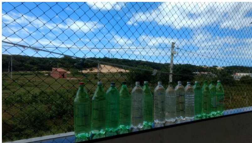
Figura 29 – Desinfecção solar utilizada como tratamento da água na subárea Loteamento
