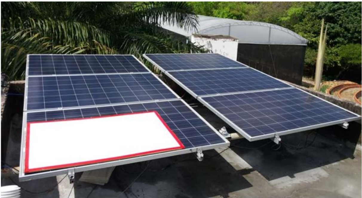
Figura 46 – Estudo de sombreamento realizado na planta FV 1.
