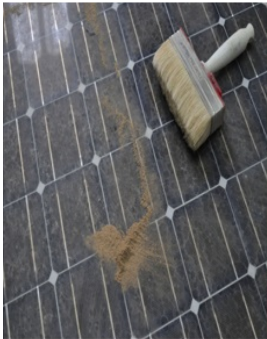
Figura 21 – Coleta da sujeira do módulo FV.
