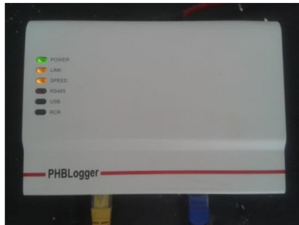
Figura 29 – Datalogger da Planta FV 1.
