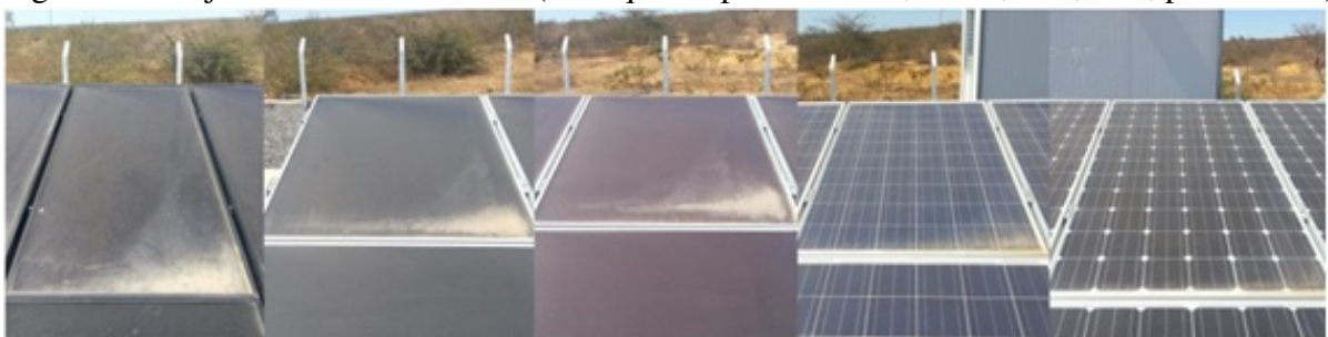
Figura 15 – Sujidade em módulos FV (da esquerda para a direita, CIGS, a-Si, a-Si, p-Si e m-Si).
