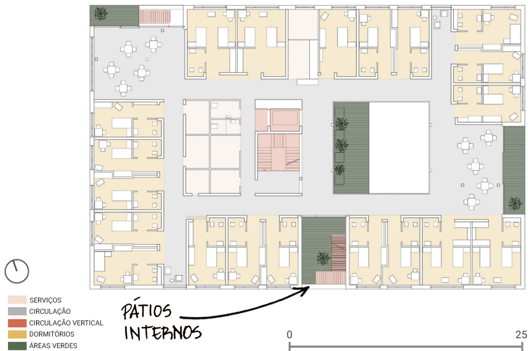
Figura 25: Planta Pav. Térreo - Lar de Repouso e Cuidados Especiais | Fonte: Archdaily - Editado pela autora
