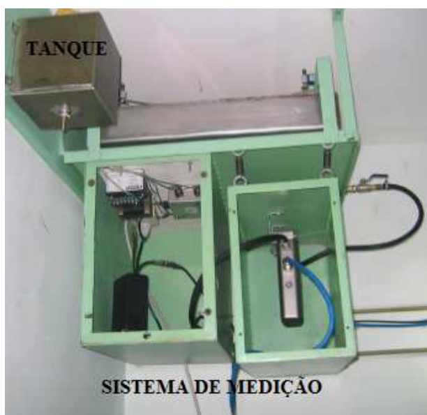
Figura 4.2. Tanque principal e sistemas de medição da vazão e massa de combustível
