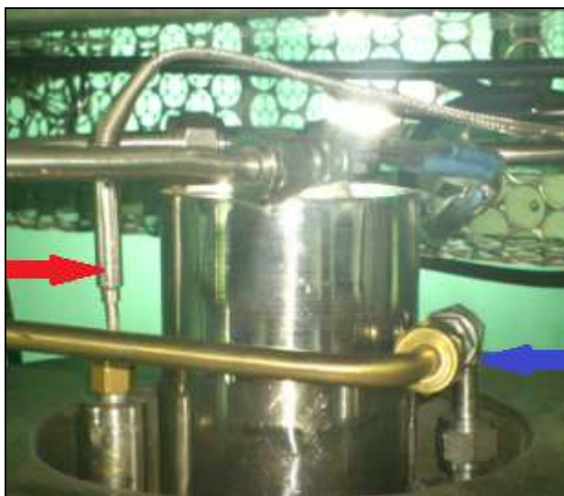
Figura 4.3. Foto do termopar na entrada do reator
