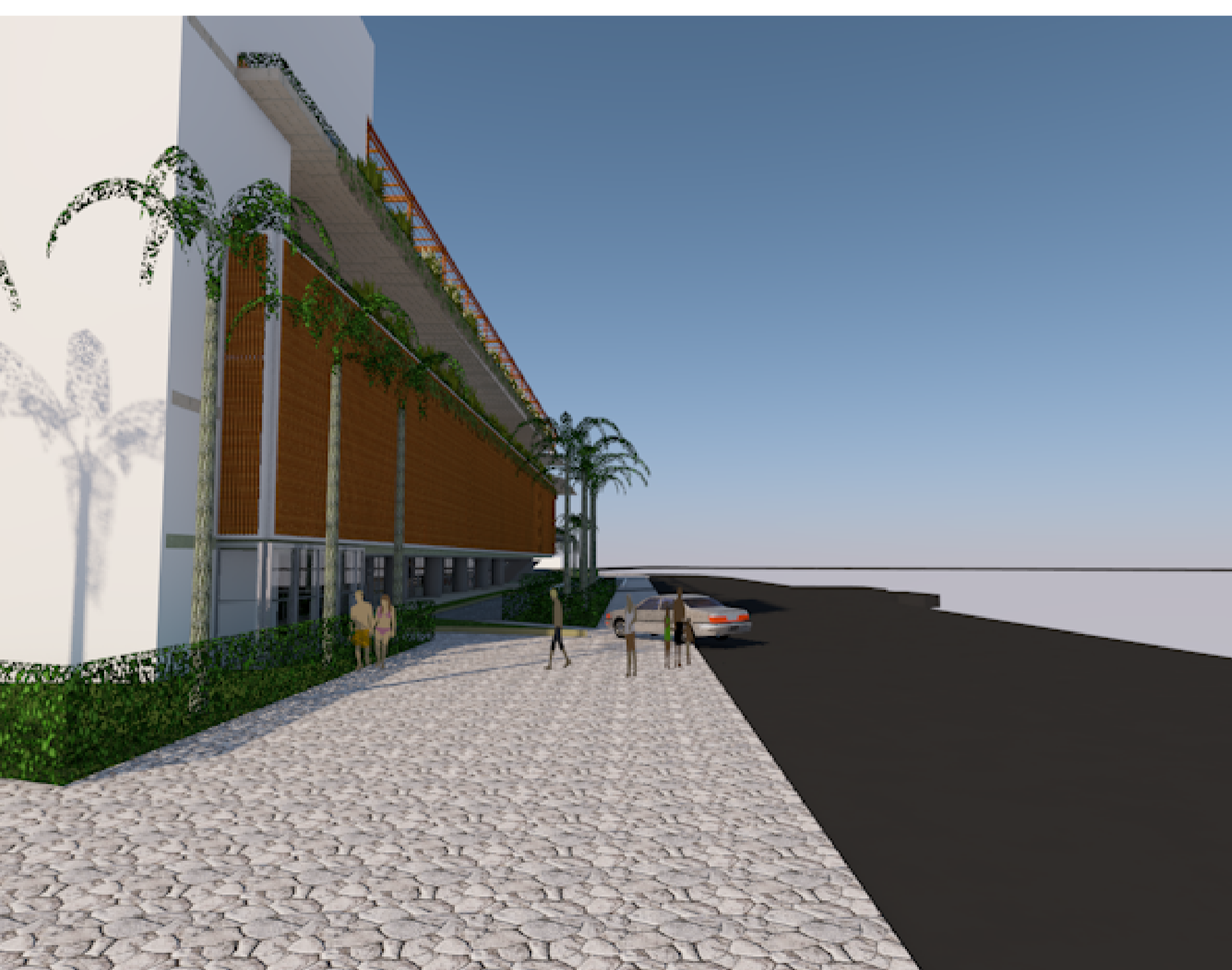
FACHADA LESTE - Focada mostrando a zona de amplo calçamento, realizado com piso para ajudar na permeabilidade e no fluxo de águas pluviais
