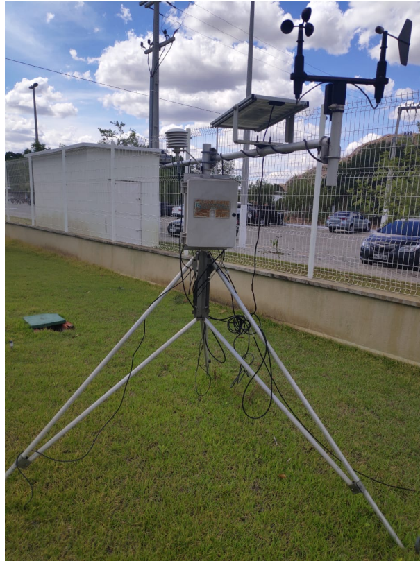
Figura 7 – Estação meteorológica da UFC - campus Quixadá
