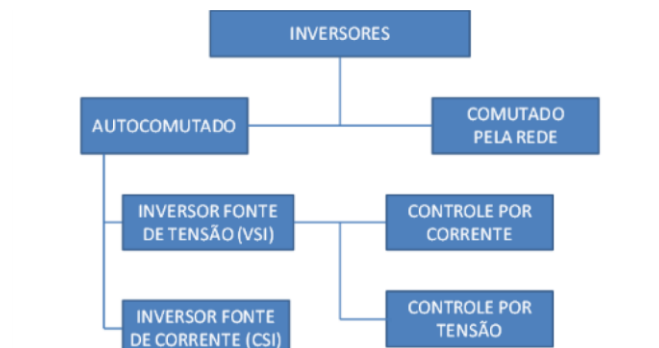
Figura 14 - Tipos de inversores classificados de acordo com o princípio de funcionamento
