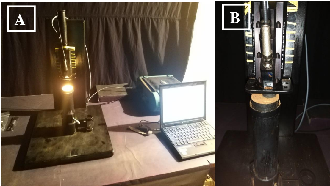
Figura 12: Em A, o equipamento FielSpec Pro Fr 3 acoplado na sonda de contato na sala escura, e em B a sonda de contato fazendo a leitura da amostra.
