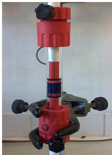
Figura 13. Coluna para ensaios cromatográficos (C 10/10 da Ge Healthcare) empacotada com esferas do adsorvente quitosana/alginato epoxilado com Cibacron Blue F3GA imobilizado.
