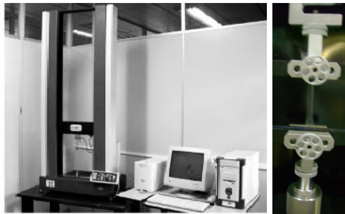
Figura 7: Máquina Universal de Ensaios – EMIC DL-3000
