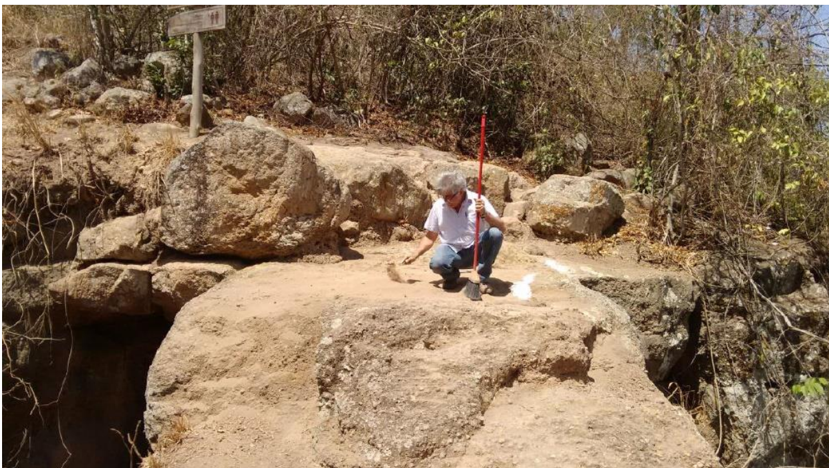
I - Limpeza das novas zonas de fissuras para colocação de curativos de gesso.
