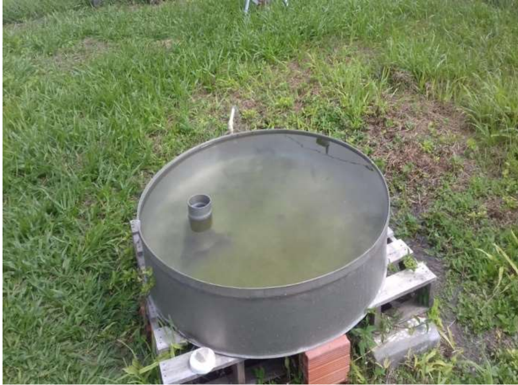
Figura 4 – Tanque classe A instalado próximo ao experimento.
