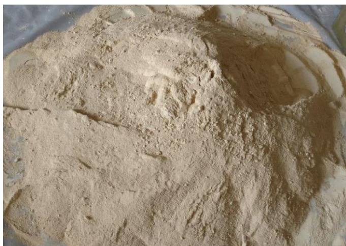
Figura 23- Aspecto do material passante na peneira 2,4mm.
