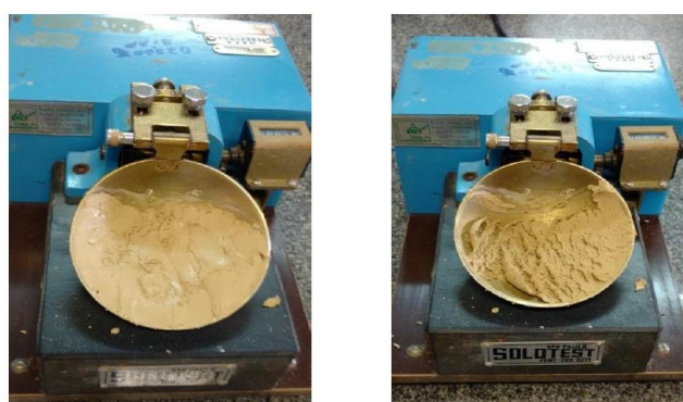
Figura 25 - Aspecto do RSPC no início e no fim do ensaio de plasticidade
