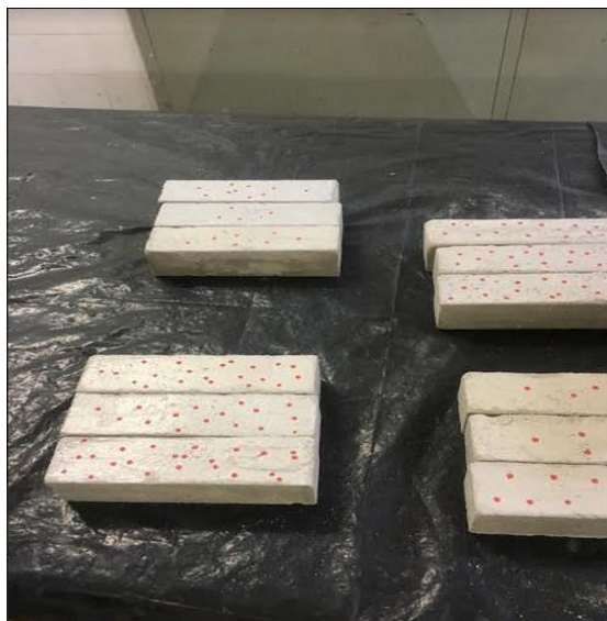
Figura 29 – Corpos de prova durante processo de cura
