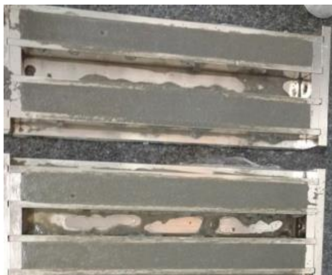
Figura 33 – Corpos de prova sendo moldados para ensaio de retração:
