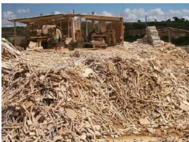
Figura 10 – Rejeitos de serragem na forma de lascas e aparas
