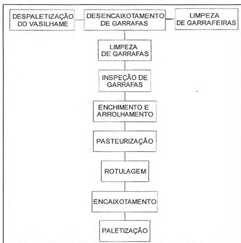
Figura 10 – Fluxograma de envasamento de cerveja – garrafa retornável Fonte: a autora
