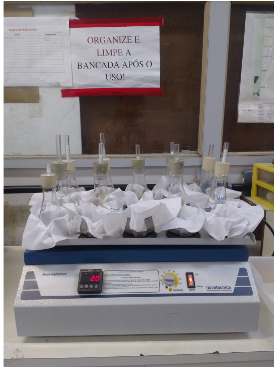
Figura 9 – Análise de carbonato nas amostras de corais e sedimento na mesa agitadora.
