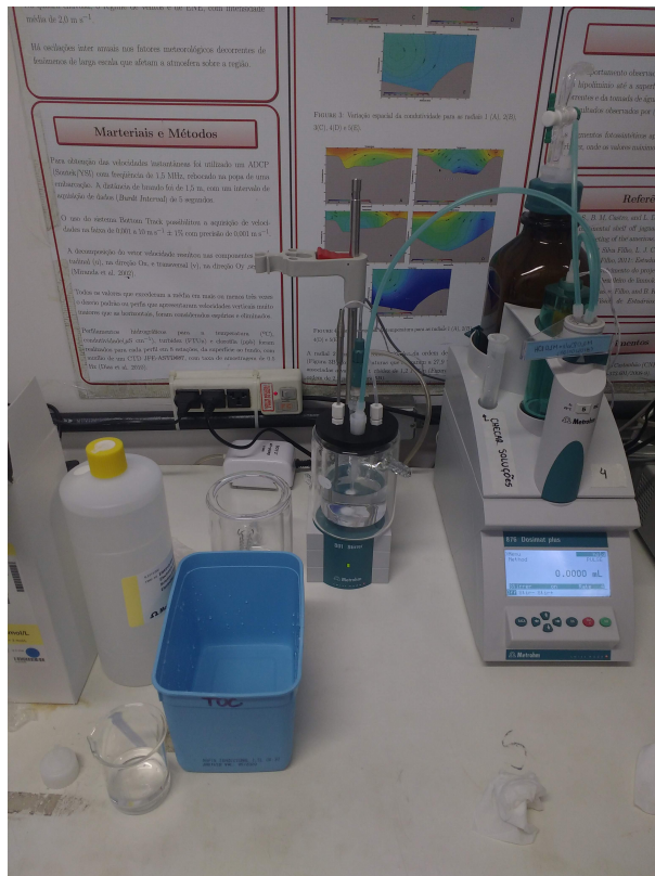
Figura 5 – Titulação automática para alcalinidade total de Dickson.
