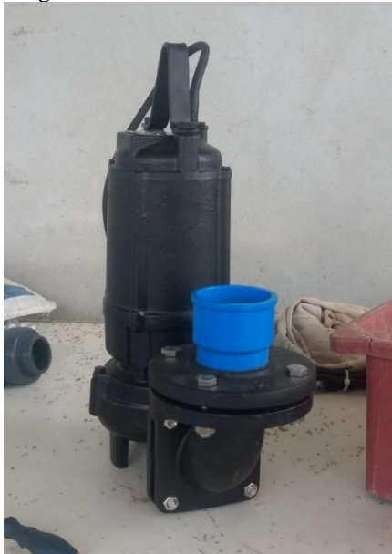
Figura 4 – Bomba de dreno central.
