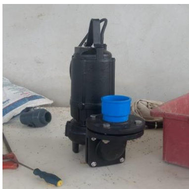
Figura 20 – Bomba do Dreno Central
