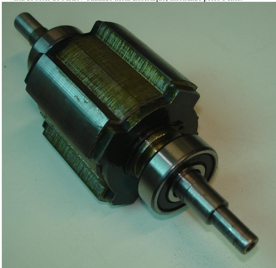
Figura A.4 – Vista do rotor do MRRV utilizado nesta dissertação, mostrando pólos e eixo.
