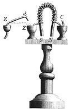
Figura 2.2 – A ferradura eletromagnética de William Sturgeon.
