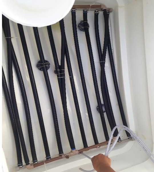
Figura 15 - Sistema de aeração no interior do transfisher .
