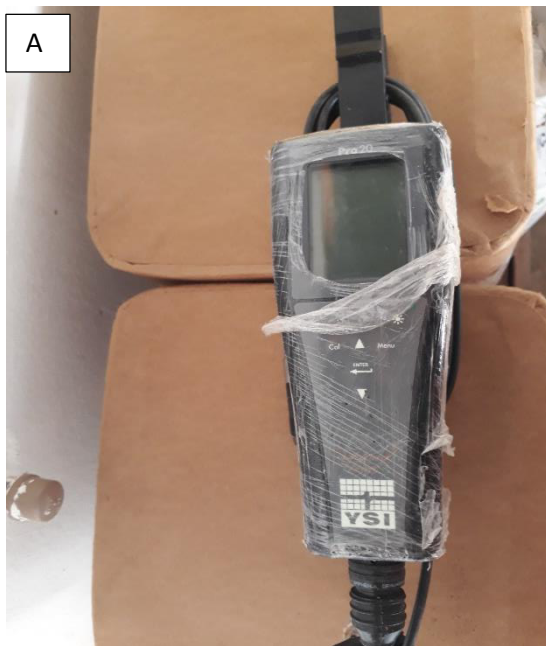
Figura 17 – Oxímetro, aparelho utilização para medição da concentração de oxigênio dissolvido na água (A) e pHmetro, aparelho utilizado na medição do pH da água (B).
