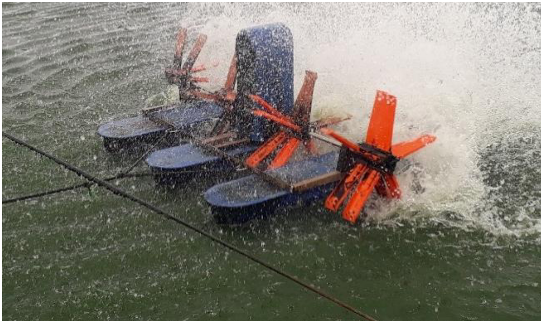
Figura 36 - Aeradores de pás.
