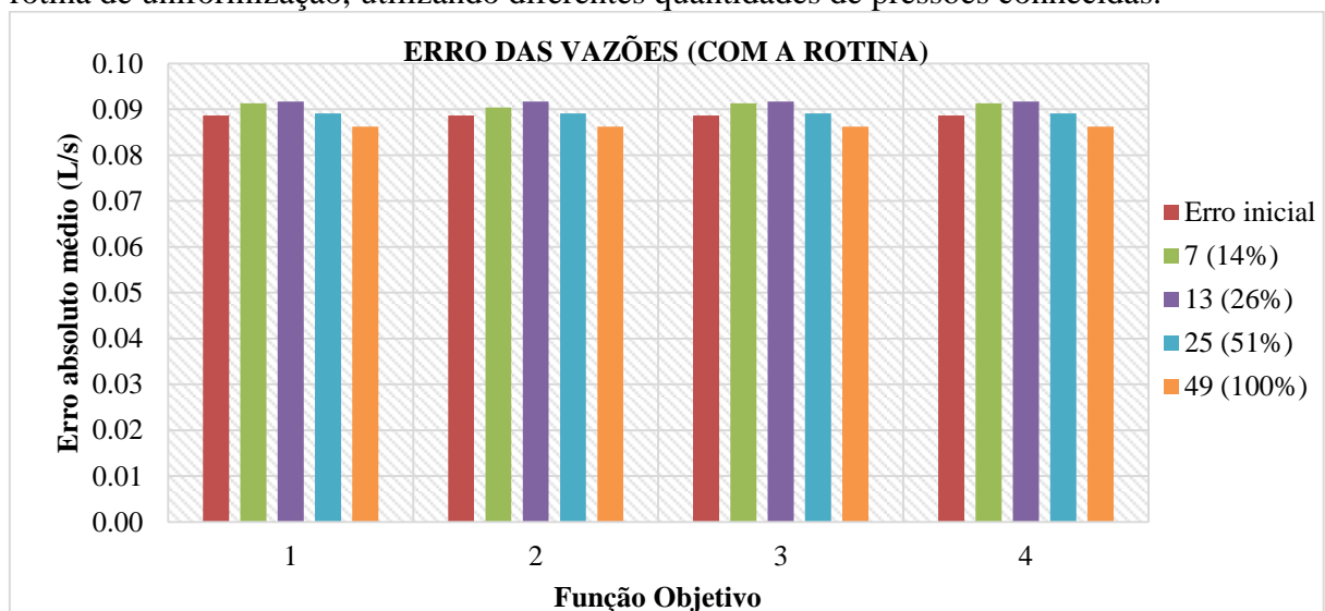
Gráfico 36 – Erro das vazões para as calibrações da Rede UFC (Hazen-Williams), com a rotina de uniformização, utilizando diferentes quantidades de pressões conhecidas.
