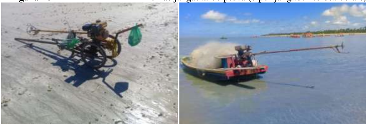
Figura 16: Motor de “rabeta” usado nas jangadas de pesca (e por jangadeiros dos corais).
