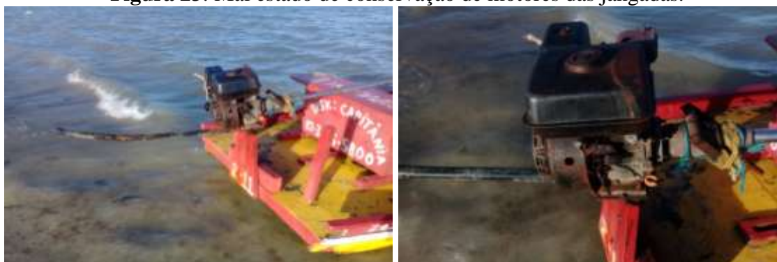
Figura 23: Mal estado de conservação de motores das jangadas.
