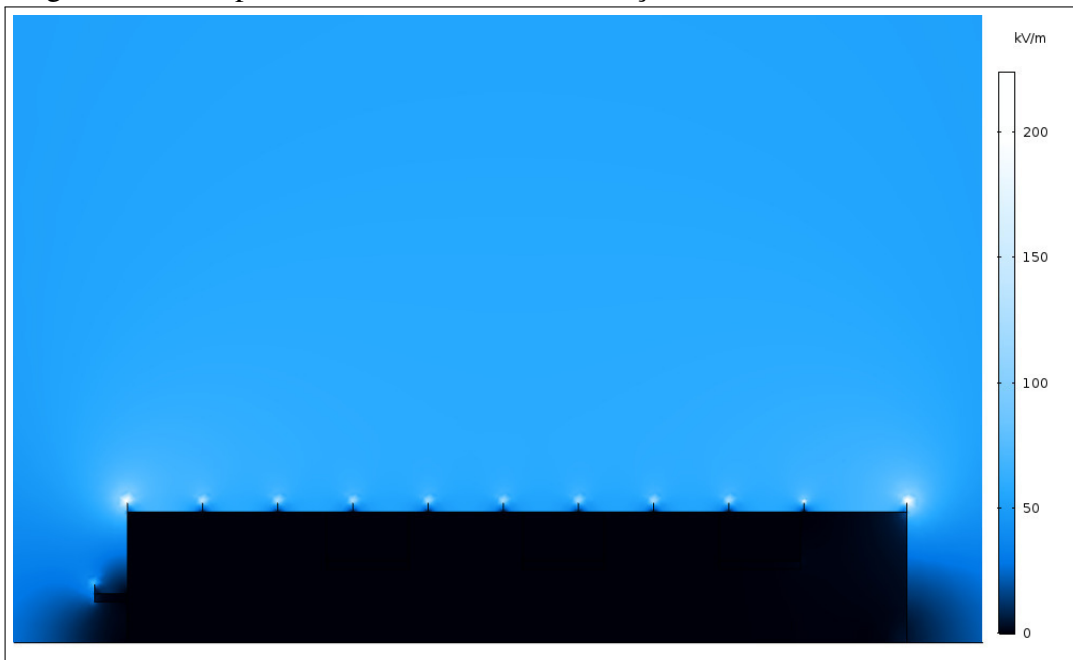
Figura 48 – Campo elétrico fachada leste instalação industrial com SPDA
