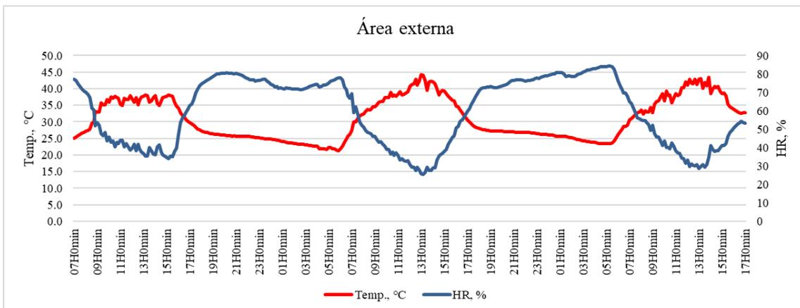
A temperatura média do ar dentro do galpão durante o período de estudo foi de 31°C e a umidade relativa média do ar de 59%. Analisando a Figura 2 é possível observar que os valores máximos de temperatura foram obtidos por volta de 13h da tarde, chegando a alcançar 36,5°C, bem como são obtidos os valores mínimos de umidade relativa do ar, que nos momentos mais quentes chegaram a 32%.
