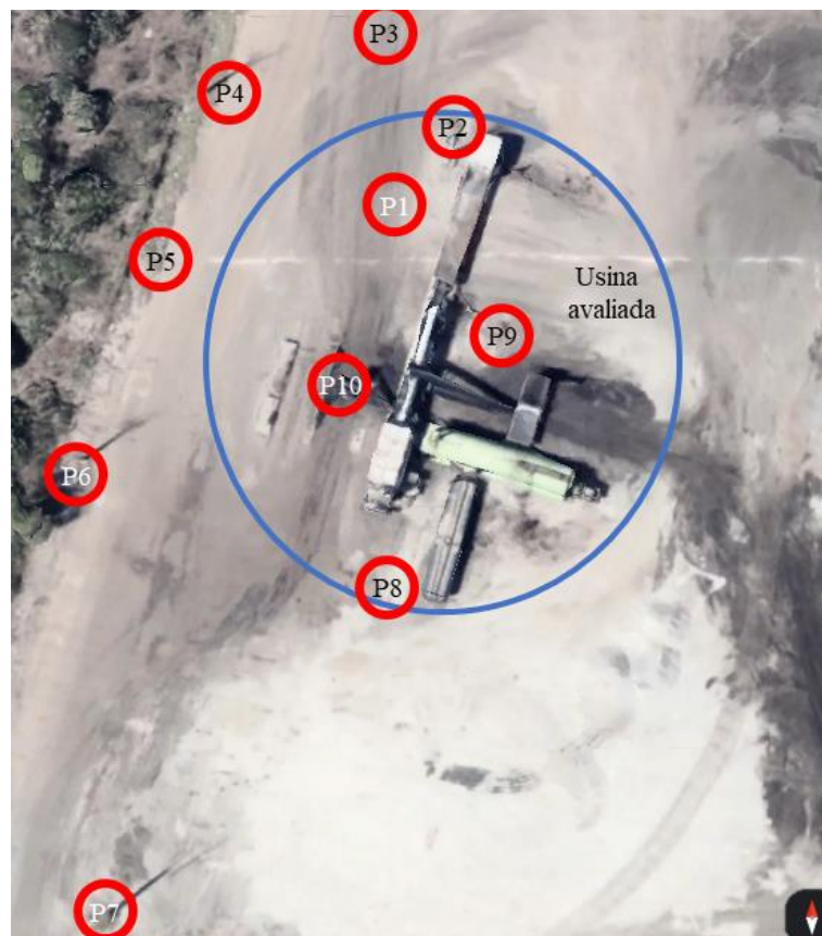
Figura 23 – Distribuição dos amostradores passivos na Usina 02
