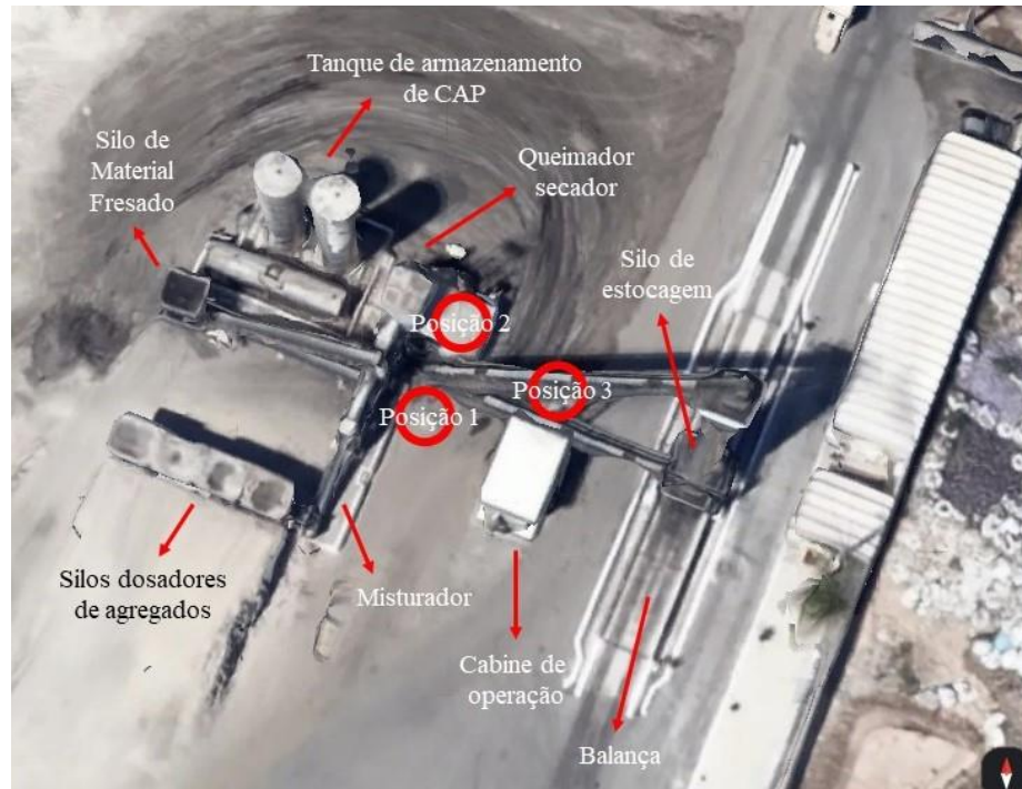
Figura 18 – Distribuição do amostrador de grandes volumes (Hi-Vol) na Usina 01
