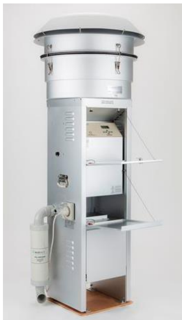
Figura 17 – Amostrador de grandes volumes utilizado para a coleta de MP
