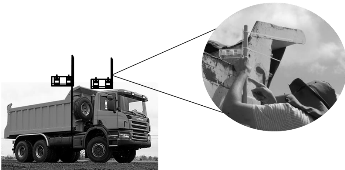
Figura 24 – Distribuição dos amostradores passivos no caminhão basculante
