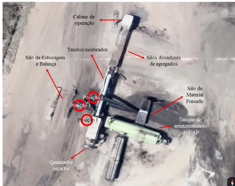
Figura 19 – Distribuição do amostrador de grandes volumes (Hi-Vol) na Usina 02
