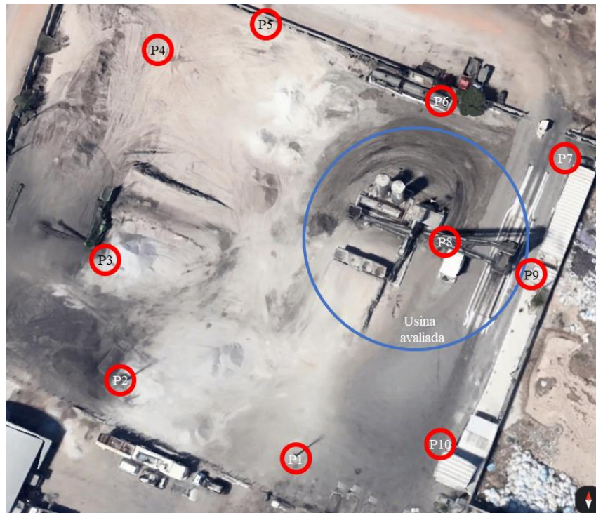
Figura 22 – Distribuição dos amostradores passivos na Usina 01
