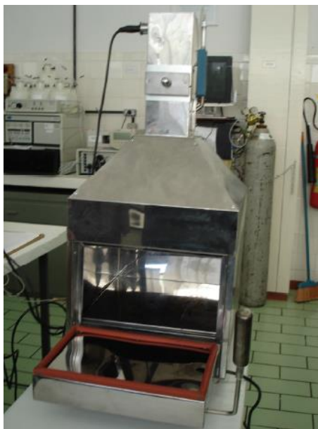
Figura 10 – Forno usado para amostragem de HPAs oriundos de emissões de ligante asfáltico
