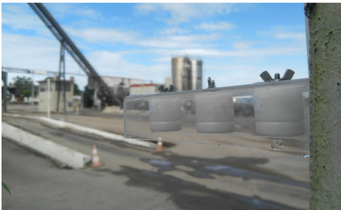
Figura 21 – Exemplo de conjunto de amostradores passivos instalado no entorno da Usina 01
