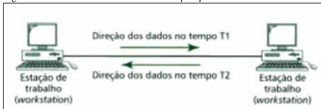
Figura 12 – Funcionamento de um canal half-duplex
