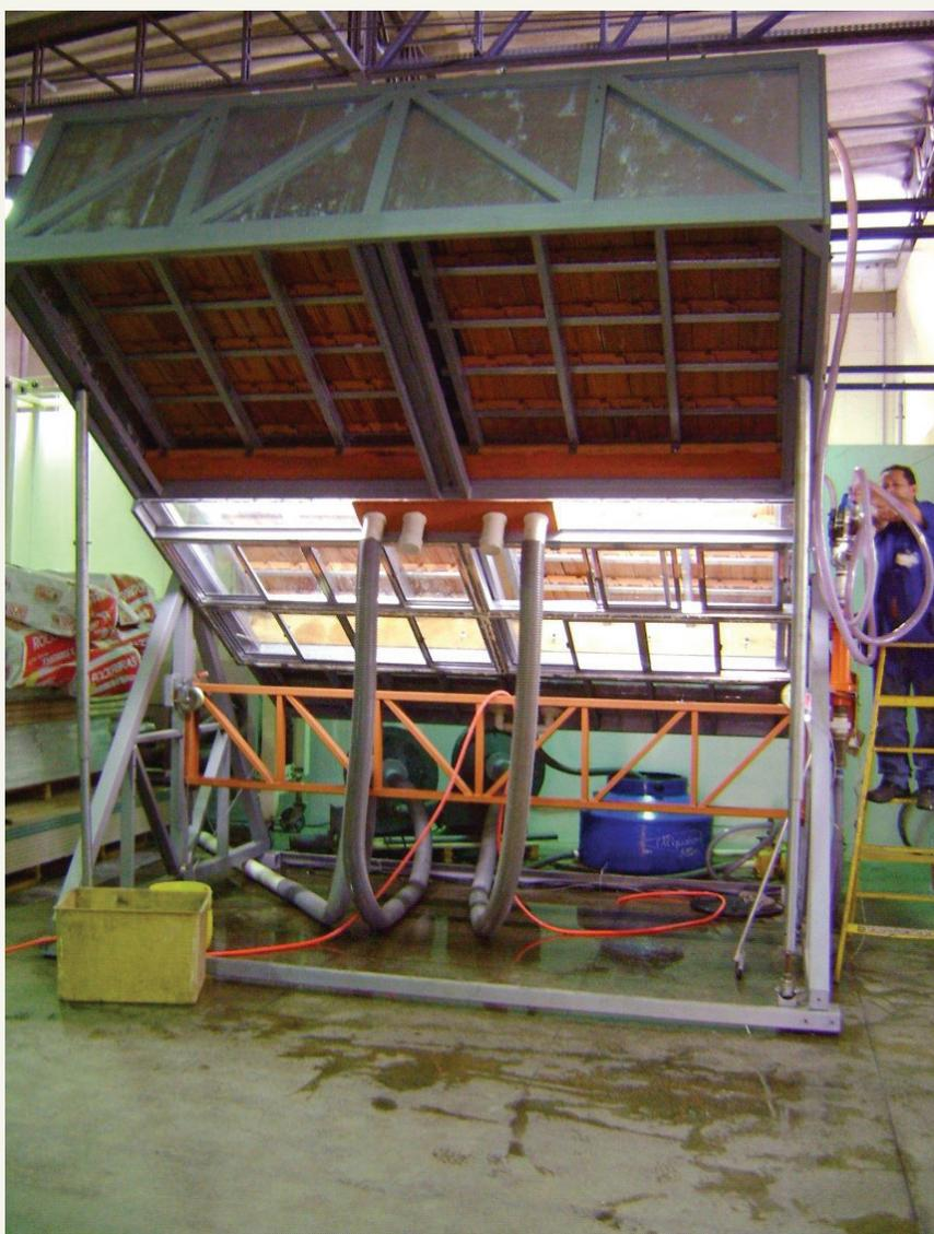
Figura 26 – Câmara para ensaio de estanqueidade de coberturas em laboratório (Fonte IPT).
