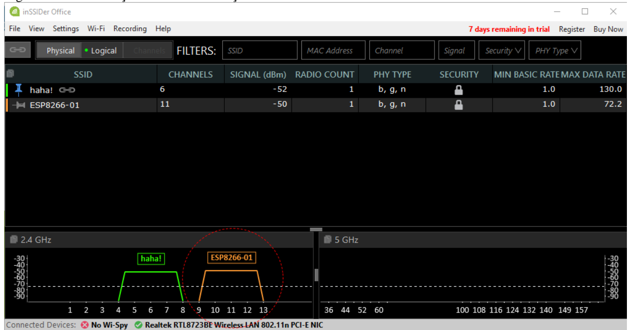
Figura 24 - Visualização do canal de atuação do ESP8266-01 via InSSIDer.
