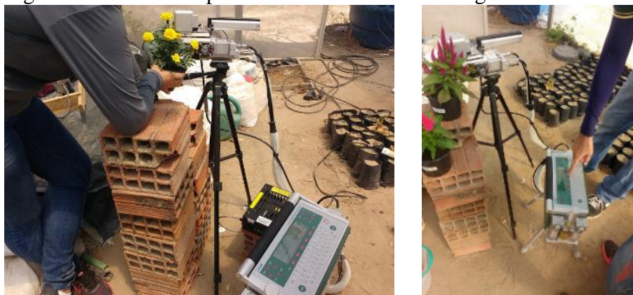
Figura 4 – Detalhe do processo de leitura das trocas gasosas
