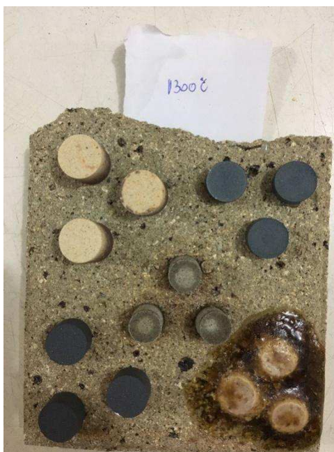
Figura 18: Pastilhas aquecidas na temperatura de 1300 °C.
