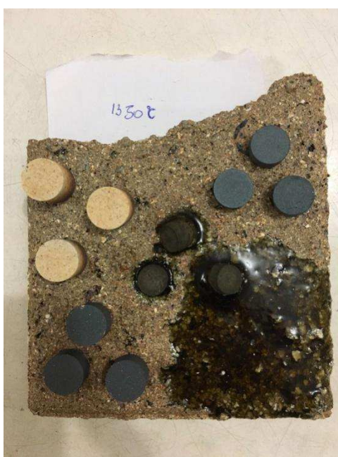
Figura 19: Pastilhas aquecidas na temperatura de 1300 °C.
