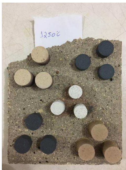
Figura 17: Pastilhas aquecidas na temperatura de 1250 °C.
