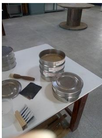
Figura 4.2: Peneiramento individual para o ensaio de granulometria.
