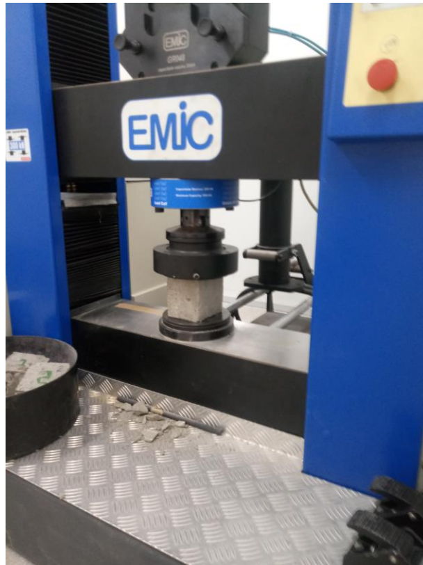
Anexo A.5: Rompimento do corpo de prova para avaliar a resistência à compressão.
