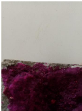
Figura 4.12: Observação de carbonatação no corpo de prova com o uso de indicador de pH.
