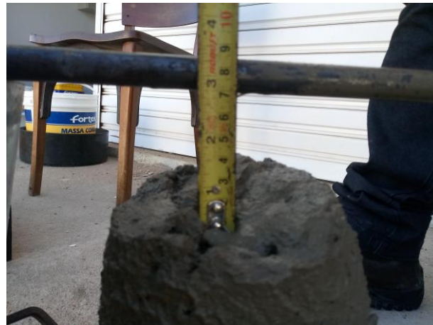
Figura 4.8: Medição do abatimento do concreto produzido.
