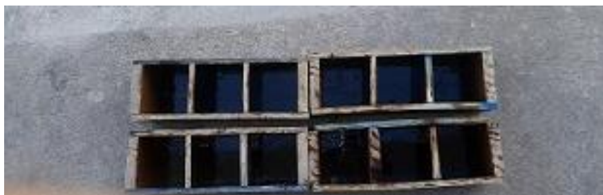
Figura 4.9: Preparação das formas para a moldagem dos corpos de prova.
