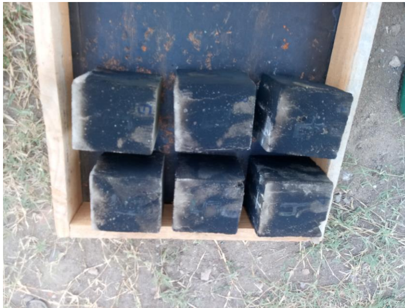
Anexo A.6: Corpos de prova após um período de exposição ao CO 2 .
