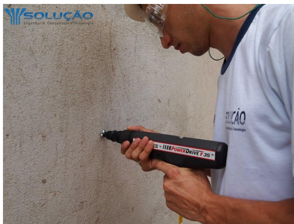
Figura 3.13: Aplicação do método de penetração de pinos.
