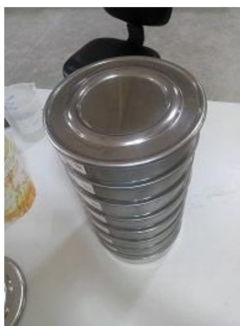
Figura 4.1: Arranjo de peneiras para ensaio de granulometria.
