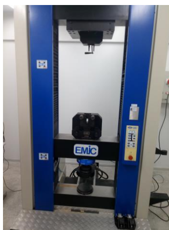
Figura 4.14: Máquina utilizada para realizar a compressão dos corpos de prova.
