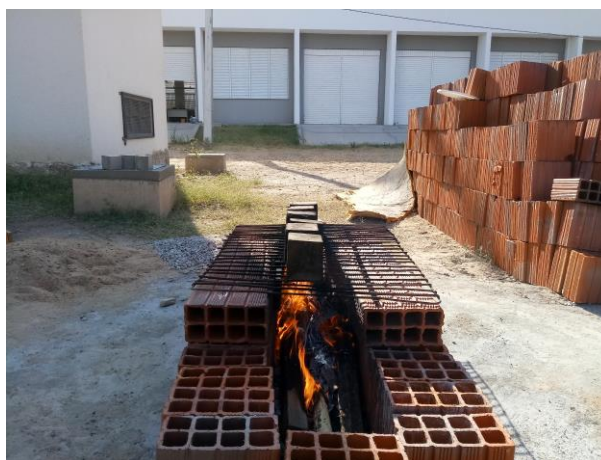
Figura 4.11: Processo de exposição das amostras ao dióxido de carbono.
