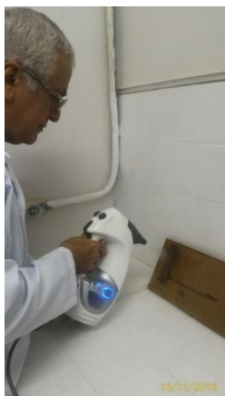
Figura 11- Aplicação de vapor na palheta fixada em um suporte
