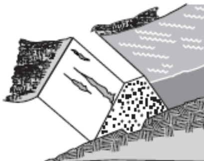
Figura 2.19 – Rachaduras Longitudinais no Talude de Jusante.
