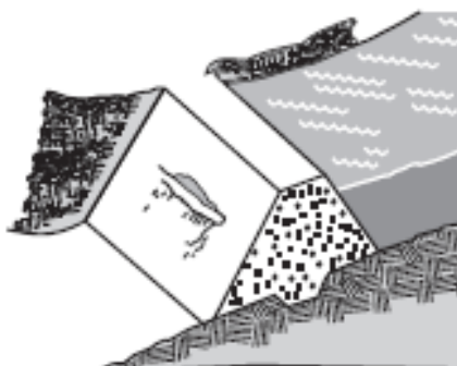
Figura 2.17 – Deslizamento no Talude de Jusante
